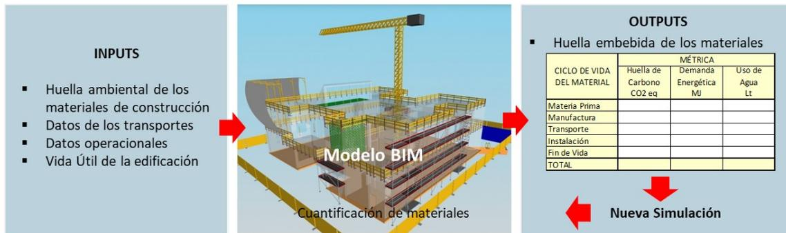
**Figura 5.** Esquema conceptual de la evaluación de la huella de carbono en los materiales de construcción
